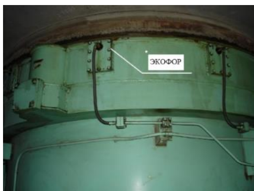
Рисунок 2. – Место подключения устройства к планетарному редуктору
