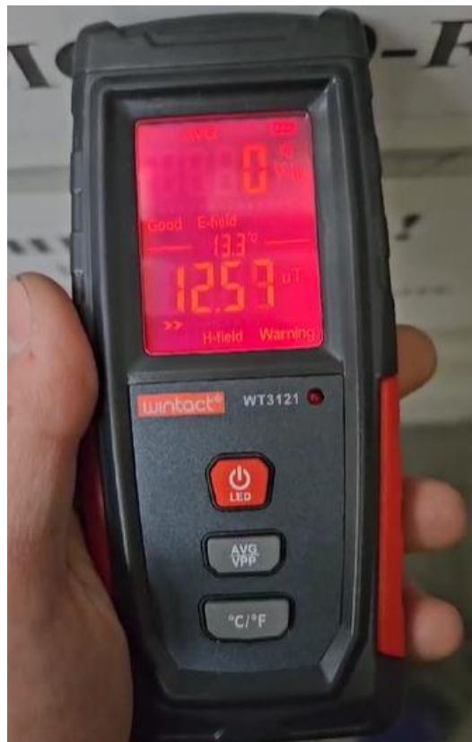
Рисунок 4 – Измерение полей электрических шкафов
