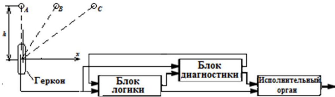
Сурет 1 - Геркондағы MT3 схемасы
