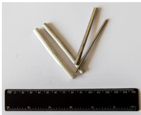
Рисунок 5 - Проволока разного диаметра, полученная из дробленых баночных отходов [8]
